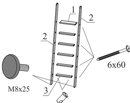
5.11. Закрепите лестницу к опоре винтом 6x60, к вилке ограждения винтом 6x40, к деталям 4 с помощью винтов 6x35. Верхнюю ступень (дет. 1) закрепите к детали 23 с помощью евровинтов 7x50.
