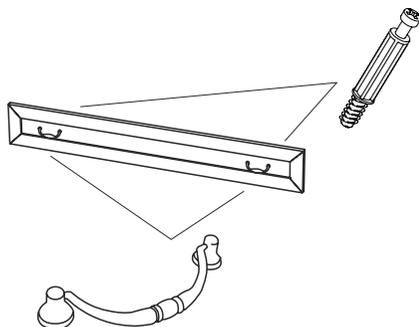
6.5. Закрепите фасад к ящику затянув эксцентрики.
