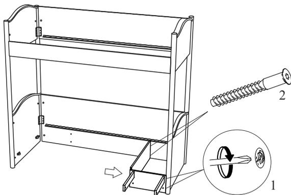
5.7. Закрепите деталь 19 к детали 8 затянув эксцентрик и к опорам с помощью евровинтов 6x13.
