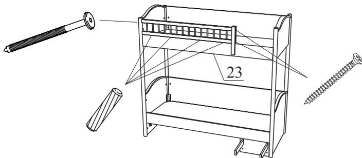
5.10. Установите в ступени (дет. 1 и 3) стяжки - бочки и закрепите к деталям 2 с помощью винтов 6x60. Закрепите ножки.
