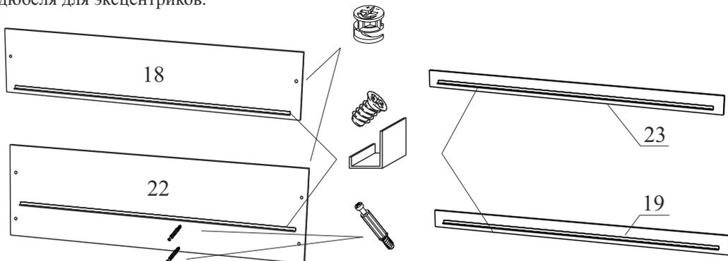
5.4. Закрепите детали 18, 22 и 23 между боковинами затянув эксцентрики и с помощью евровинтов 6x13.
