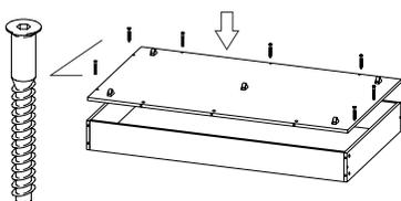
6.4. Закрепите на фасад ящика (дет. 15) дюбеля для эксцентрика и ручки.
