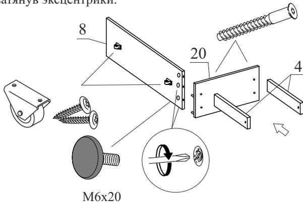
5.6. Закрепите деталь 20 к опоре затянув эксцентрики. Закрепите деталь 8 к детали 22 с помощью евровинтов 7x50.
