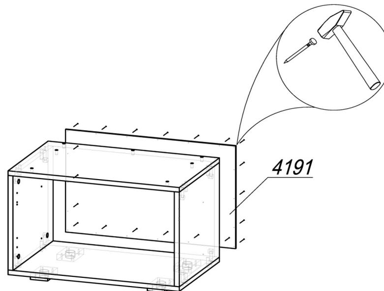
ШАГ 2. Сборка производится лицевой стороной вниз. Проверив рулеткой или рейкой равенство диагоналей, прибить гвоздями 2x20 заднюю стенку ЛДВП 4191. Поднять тумбу и установить на место. При необходимости выровнять тумбу с помощью регулировки опор.
