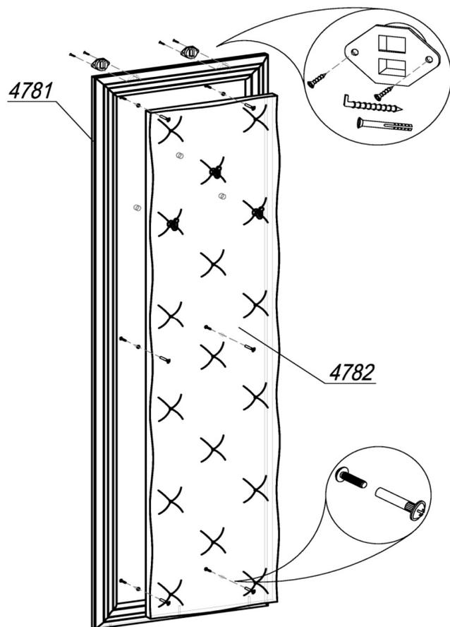
ШАГ 3. Установить в щит 4781 2 врезных навеса с помощью шурупов 4x16. Посредством винтов от межсекционных стяжек 5x32, установленных в подушку 4782, закрепить её к щиту 4781.
