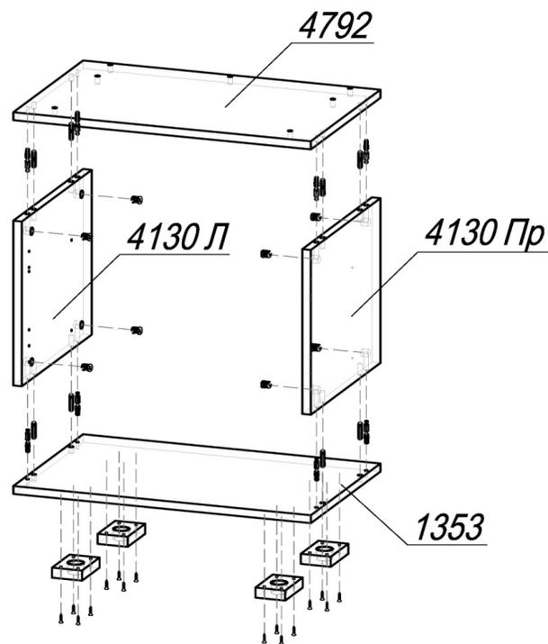
ШАГ 1. Подготовить крышку 4792 и вязку 1353 к сборке: предварительно к вязке с обратной стороны шурупами 4x16 привернуть опоры L-20 (4 шт); установить шток эксцентрика (по 4 шт в деталь) в глухие отверстия Ø5мм и шкант (по 4 шт в деталь) в глухие отверстия Ø8мм. Затем, соединить крышку 4792 и вязку 1353 с боками 4130Л и 4130Пр, установить эксцентрик Minifix (8 шт) и закрепить шток эксцентрика.
