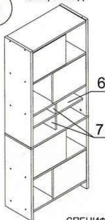
Собрать крестовой элемент стеллажа при помощи шкантов (9) Установка крестового элемента производится без использования фурнитуры в свободную секцию стеллажа. Крестовой элемент является не обязательным элементом стеллажа и может не использоваться. Поставить декоративные заглушки (5) и (12) в местах установки евроинтов (2) и стяжек-растекс (11) ..
