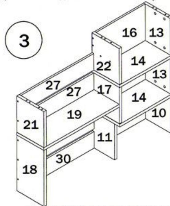
вставив между ними стенку заднюю 16 с использованием шкантов. Соединить планки 27 с боковиной 21 и соединить их с деталью 22.
