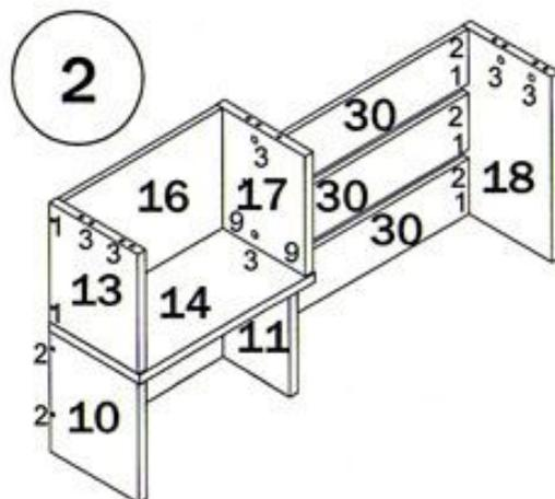
2. Закрутить в муфты полки 14 дюбеля стяжек-растекс (4), и соединить ее с деталями 10 и 11. Забить шканты (9) в полку 14. Прикрутить держатели стекла (6) при помощи саморезов (5) к боковине 13. Соединить детали 13, 16 и 17 и установить их на полку 14. Фиксацию стяжек-растекс произвести путем поворота их по часовой стрелке. Соединить планку 30 с деталями 18 и 17 как указано в п.1.
