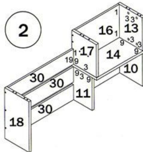
3. Закрутить в муфты полки 19 дюбеля стяжек-растекс (4) и соединить полку с деталями 18 и 17. Фиксацию со стойкой 17 произвести при помощи евроинтов (2), с боковиной 18 стяжками растекс (3). Забить шканты (9) в полку 19 так, чтобы выступающая часть шканта составила примерно 20 мм. На детали 17 и 13 установить полку 14.
