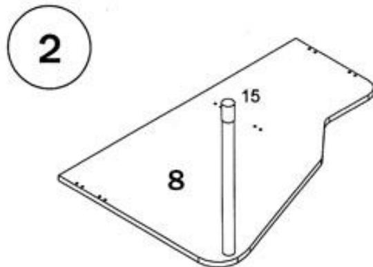
2. Прикрутить к столешнице 8 опору (15) при помощи саморезов (20). Закрутить дюбеля стяжек (4) в муфты столешницы (8) (см. рис.2)
