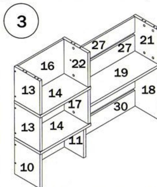
вставив между ними стенку заднюю 16 с использованием шкантов. Соединить планки 27 с боковиной 21 и соединить их с деталью 22.
