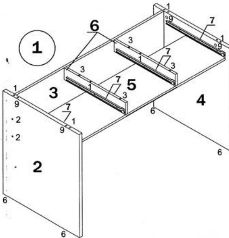
с деталями 3 и 4 при помощи евровинтов (2) и шкантов (1). Соединить стойки 5 с полкой 3 при помощи евровинтов (2)
