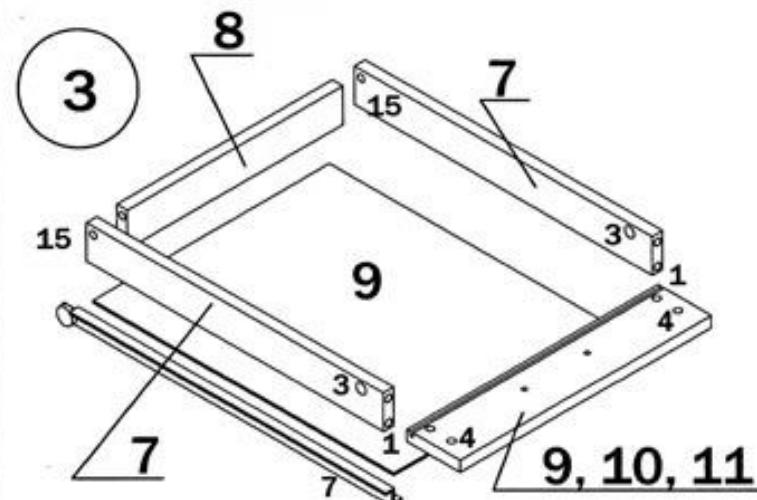
имеющейся на передних панелях 9, 10, и 11, вставить дно ящика 9 до упора. Затем выровняв дно ящика 9 по периметру с боковинами 7 и задней стенкой ящика 8
