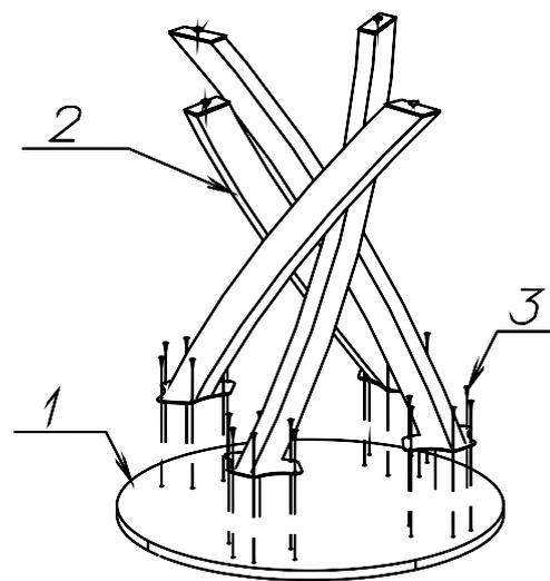
3. Выставить площадки опоры стола на расстоянии 1,5-2 см от края столешницы. Закрепить опоры стола при помощи шурупов 4x16 крестовой отверткой или аккумуляторной дрелью.
